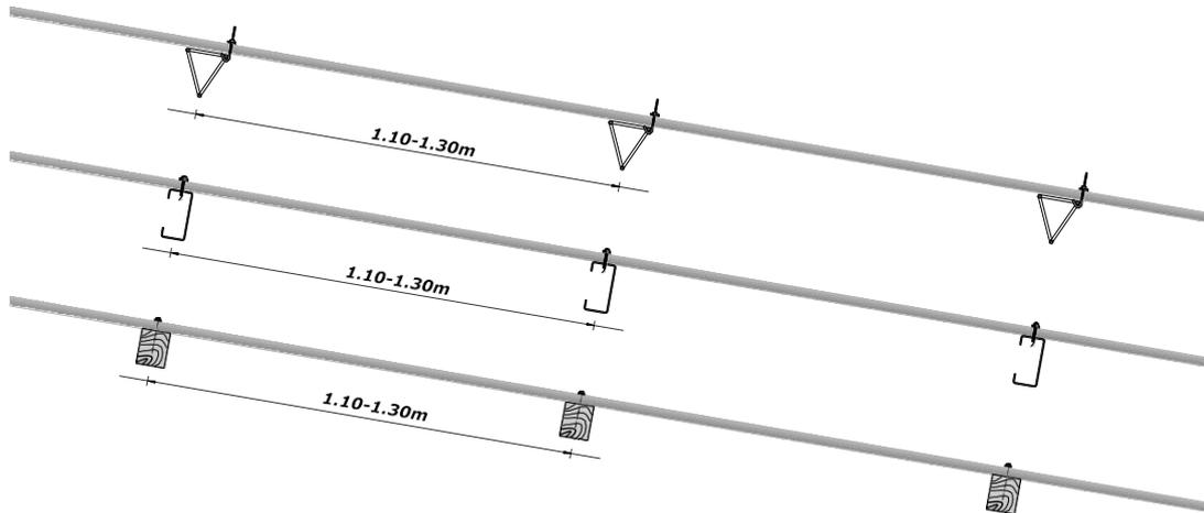
Las líneas de apoyo de la cubierta son perpendiculares al largo de la chapa y se recomienda una distancia entre las mismas no mayor a 1.3 m.
