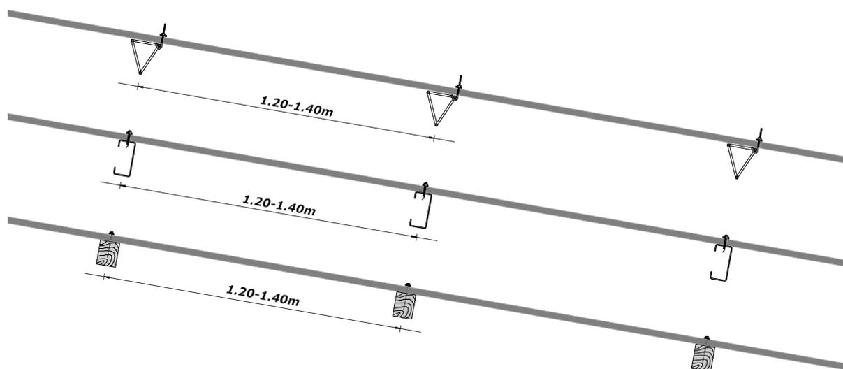
Las líneas de apoyo de la cubierta son perpendiculares al largo de la chapa y se recomienda una distancia entre las mismas no mayor a 1.4 m.
